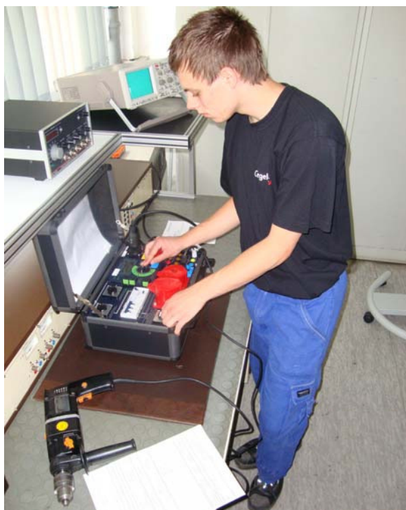
Abb. 2 1) : Wiederholungsprüfung an einem elektr. Gerät
